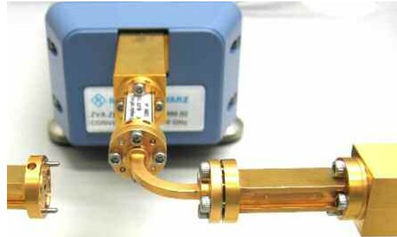
Abb. 4.8b: „Through“-Verbindung zwischen Hohlleitermesstor 2 und 4
