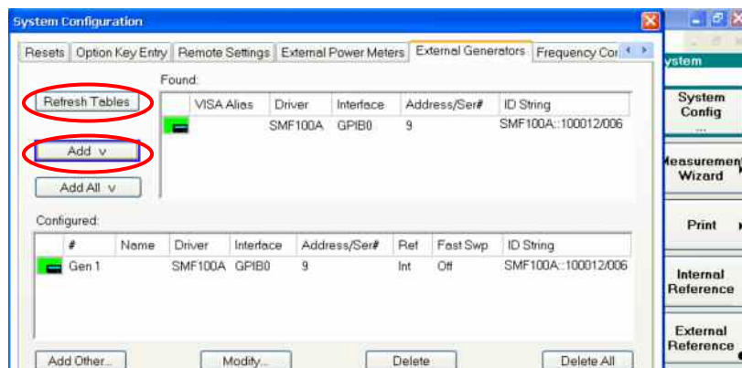
Abb. 4.14: Konfiguration des externen Generators
