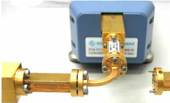
Abb. 4.8a: „Through“-Verbindung zwischen Hohlleitermesstor 1 und 4
